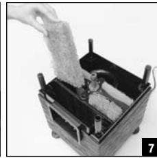
Le filtre SkimAway est vendu avec quatre (4) plaquettes filtrantes - deux (2) de texture large et deux (2) de texture fine. Afin d'optimiser leur efficacité, placer les deux plaquettes de texture large tout près de l'entrée d'eau et les plaquettes de texture fine derrière les plaquettes de texture large. Les masses filtrantes biologiques comme Phos-X Laguna (non comprise), peuvent être déposées dans la section du panier, derrière les plaquettes de filtration mécanique. (**Fig. 6 et 7**).
